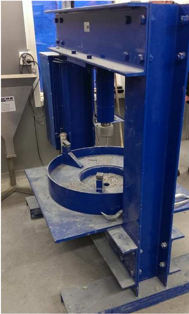
Figur 5 Provutrustning enligt ASTM C1550-12a
